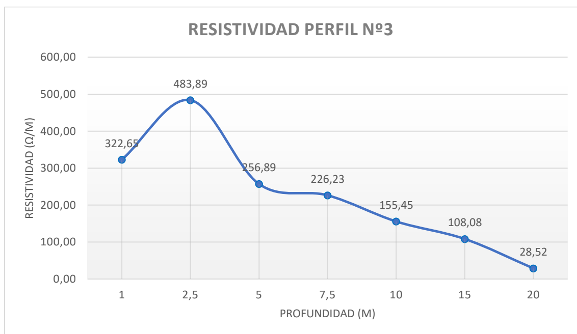
Figura 6: Diagrama de la relación de entre resistividad y profundidad.
