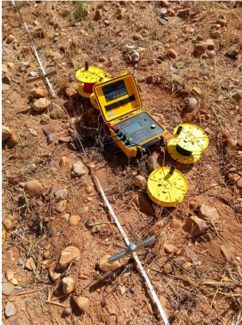
Imagen 1. Ensayo de resistividad eléctrica 1
