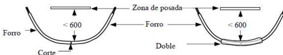
Figura 5b: Instalación cubiertas en puentes
