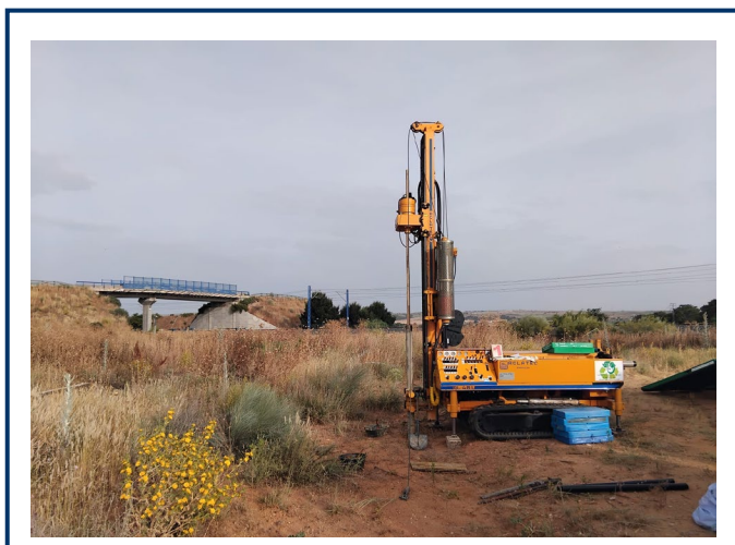
Figura 5. Sonda de perforación utilizada.
