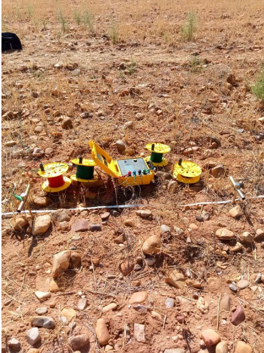
Imagen 2. Ensayo de resistividad eléctrica 2
