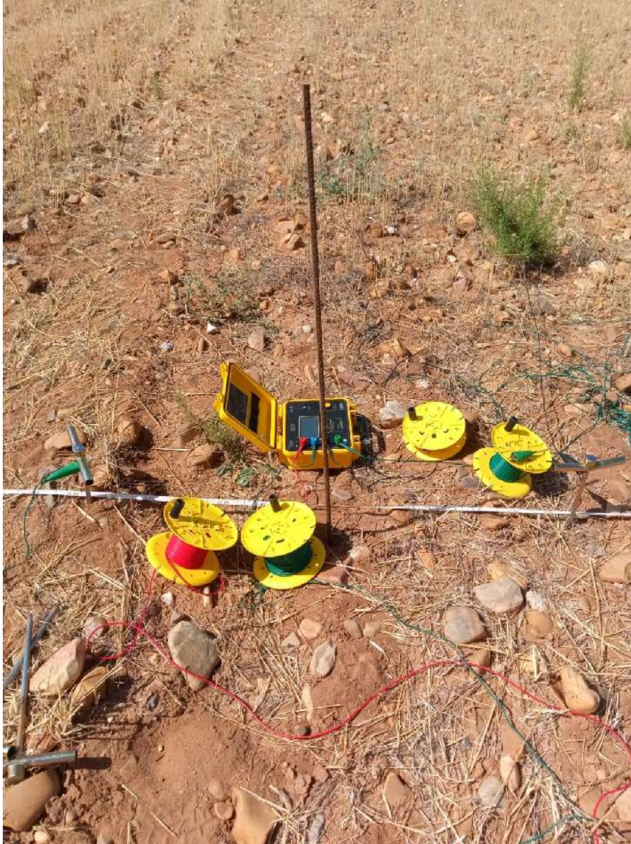
Imagen 3. Ensayo de resistividad eléctrica 3
