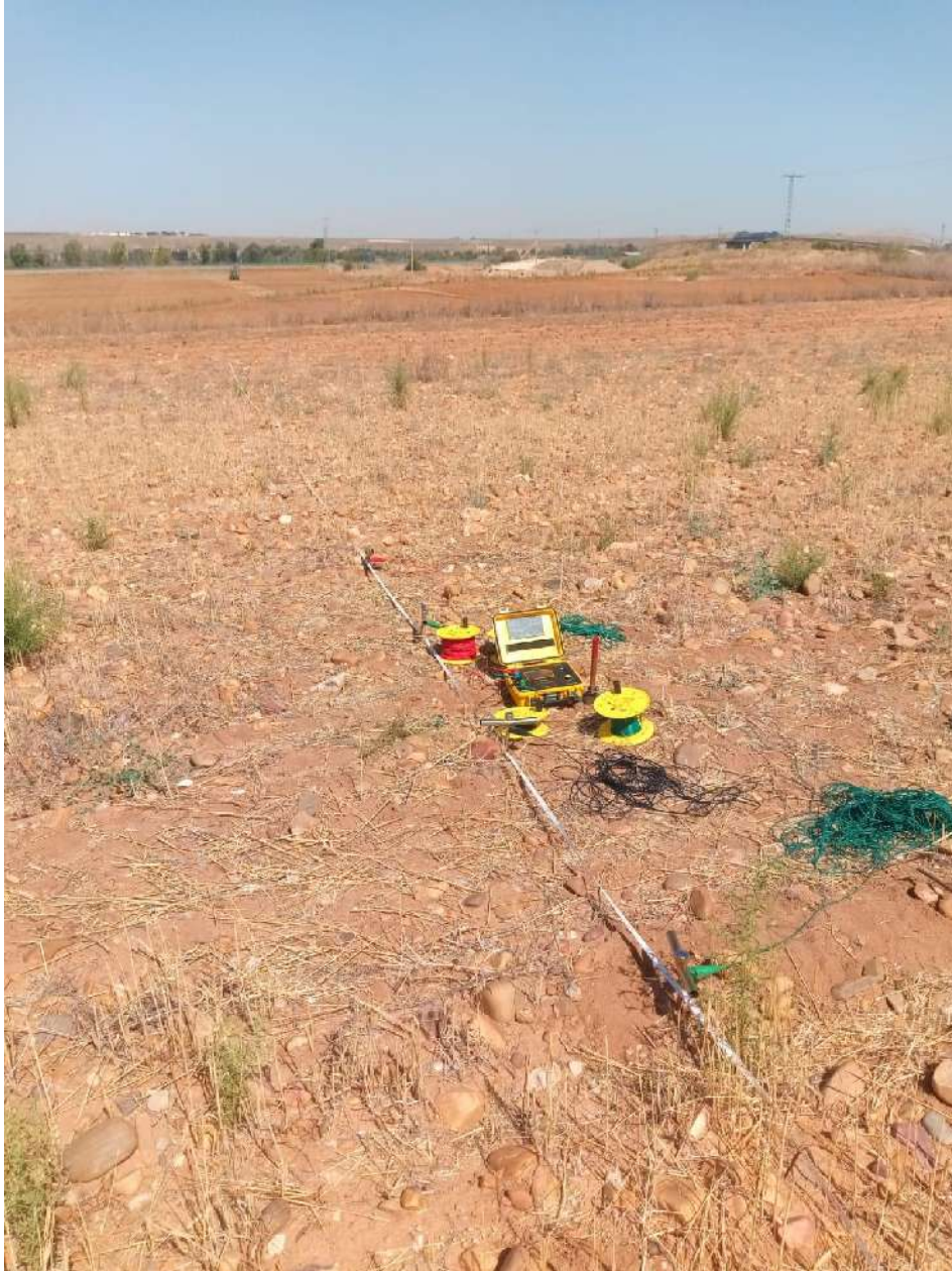
Imagen 4. Ensayo de resistividad eléctrica 4
