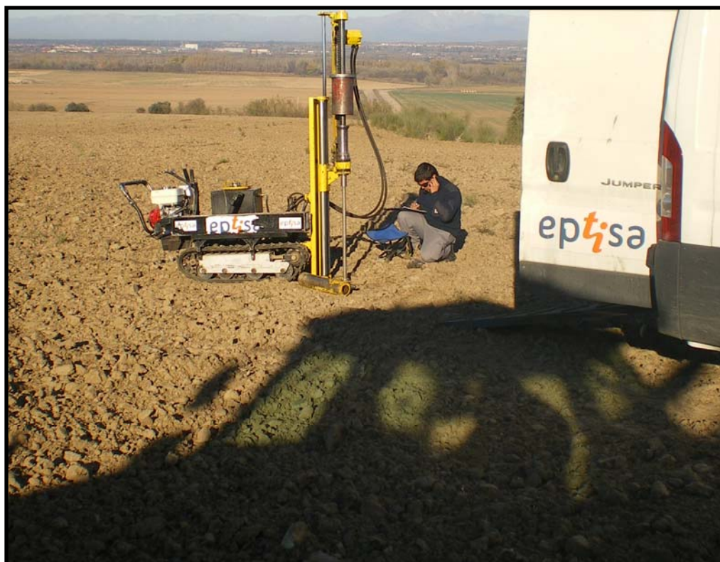
PP-11.1. TOLEDO. EQUIPO EMPLEADO EN LOS ENSAYOS DE PENETRACIÓN DINÁMICA TIPO BORRO
